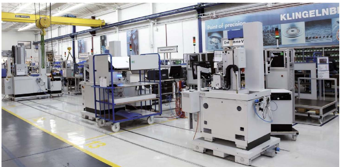
KLINGELNBERG stellte von Boxen- auf Fließmontage um. Die ausgewählte Lösung von STROTHMANN lässt die Schienen so weit im Boden verschwinden, dass z.B. Rollregale sich leicht darüber bewegen lassen.
