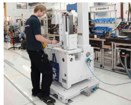
Mobiler Steharbeitsplatz mit deutlich sichtbaren Nivellierplatten im Boden.
